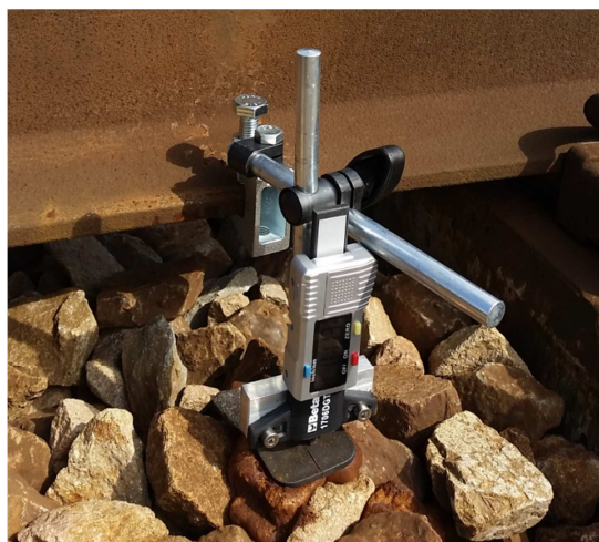
Rys. 8 Liniał elektroniczny do pomiaru ugięć dynamicznych szyny
