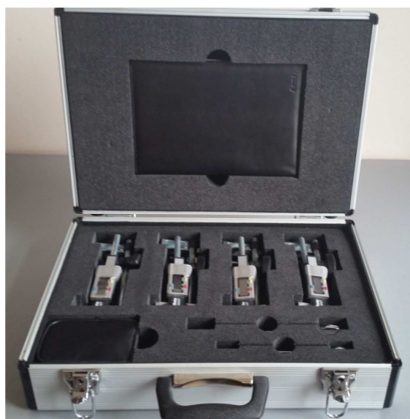
Rys. 7 Zestaw pomiarowy do diagnozowania stref przejściowych
