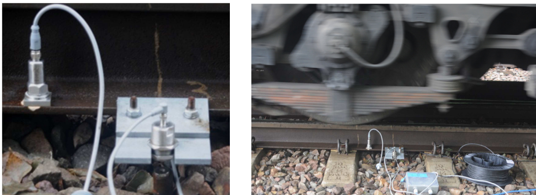
Rys. 3 Pomiar ugięć dynamicznych i przyspieszeń pionowych szyny
