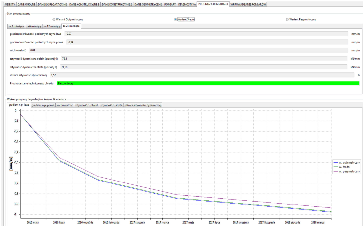
Rys.19 Okienko z prognozą degradacji geometrycznej (deformacji) oraz degradacji mechanicznej (szywności dynamicznej)
