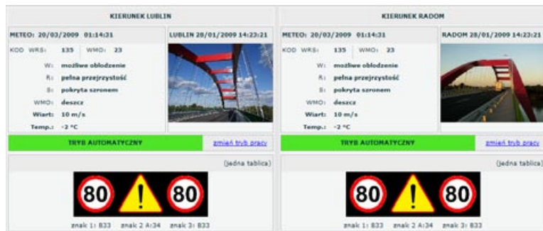
Rys. 6. Przykładowe okno dialogowe służące do zarządzania znakami zmiennej treści. Widoczne są dane pochodzące ze stacji meteorologicznej oraz podgląd obrazu z kamer
