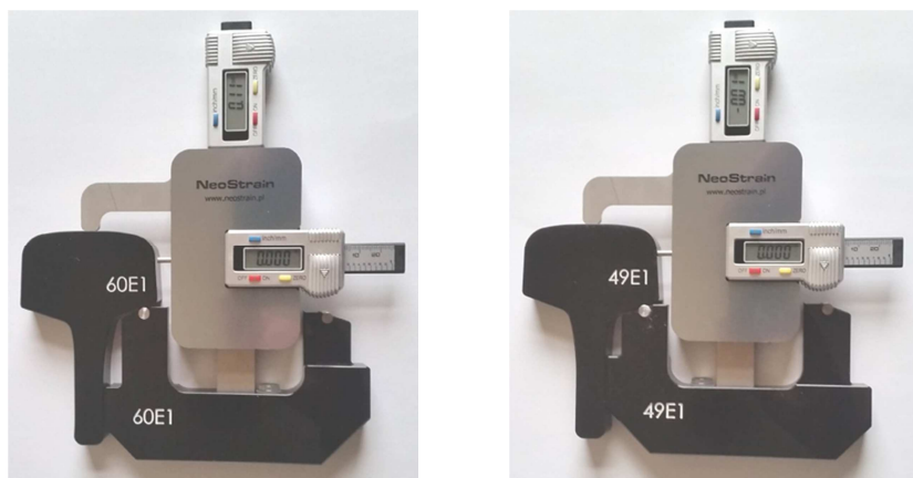
Rys. 2. Zerowanie linaiałów profilomierza na wzorcu szyn 60E1 oraz 49E1
